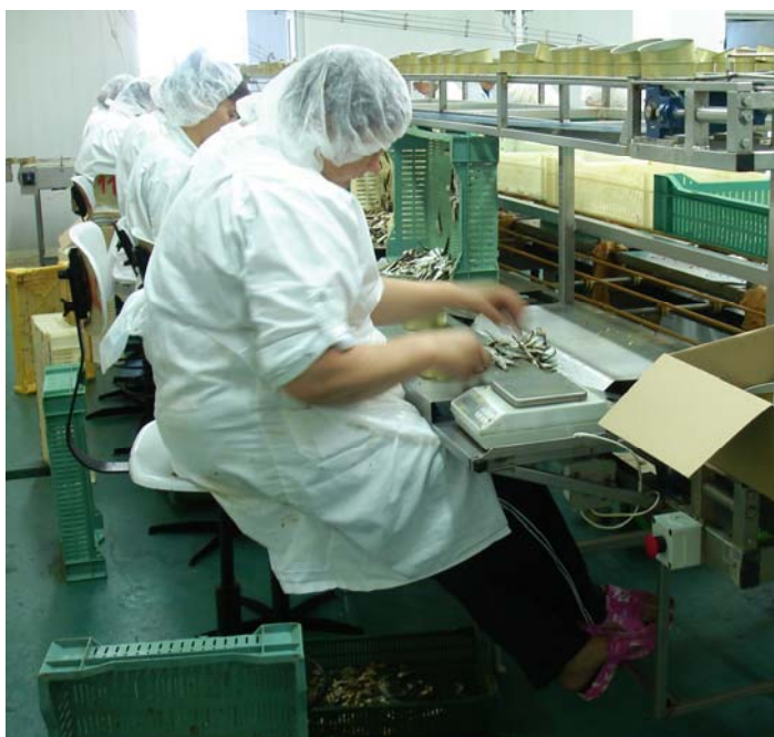
Šajā attēlā kurš uzņemts 2007. gadā, redzams, ka darbinieki, neraugoties uz krēsla muguras balstu, nevar ieņemt pareizu darba pozu, jo krēsls savas konstrukcijas dēļ nevar pildīt ergonomikas funkcijas.
