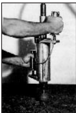
Attēls 5.1.: Rokturi ar amortizētu vibrāciju, kas piestiprināti parastajam pneimatiskajam blietētājam.
