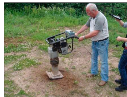
Trokšņa un plaukstu-rokas vibrācijas mērījumi darbā ar vibropēdu
