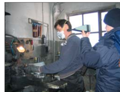
Trokšņa līmeņa mērījumu veikšana virpotāja darba vietā
