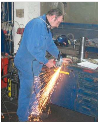
Abrazīvo putekļu mērījumi metāla griešanas laikā
