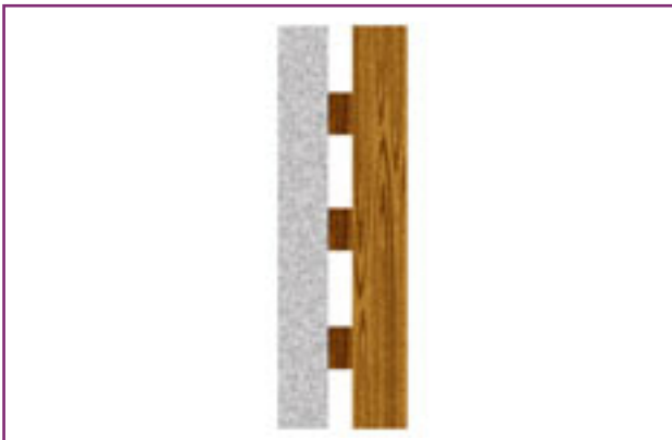
3. 7. attēls. „Diafragmas” ir koka plātnes, kas ar koka listēm piestiprinātas pie sienām. Tās vājina zemas frekvences skaņas.
