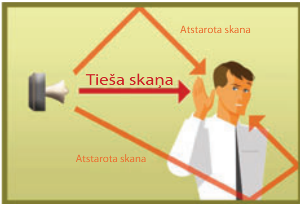
3.1. attēls: Skaņa, ko izstaro akustiskais avots, tiek atstarota uz darba vietas sienām. Darba ņēmējus ietekmē atstarotās skaņas un tiešās skaņas apvienojums.
