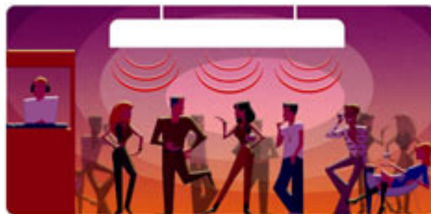
8.1. attēls Diskotēka ar akustiskajiem griestiem, kuros divu galveno skaļruņu vietā iemontēti vairāki skaļruņi
