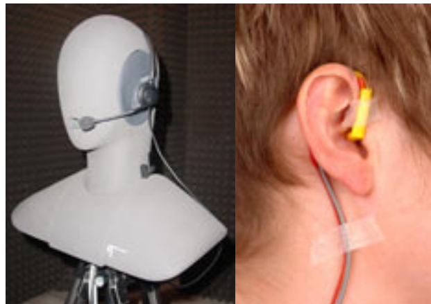
2.13. attēls Trokšņa mērījumi auss tuvumā, izmantojot HATS un MIRE metodes Fotoattēli © publicēti ar Veselības un darba drošības izpildu komitejas atļauju, Lielbritānija Galvas un torša makets (HATS) (avots HEAD Acoustics GmbH, Vācija) Austiņsisstēma (MIRE)
